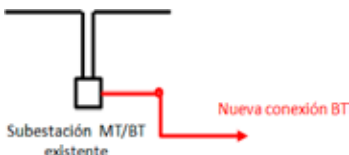
Figura 1. Conexión radial desde una subestación secundaria.
